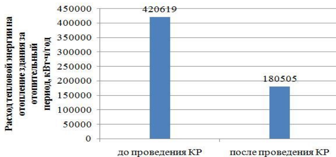
Рис. 2. Расход тепловой энергии на отопление здания за отопительный период, кВт · ч/год до и после проведения КР.
