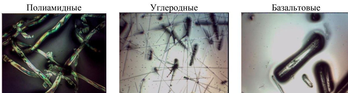
Рис. 1. Микрофотографии волокон в клеевой плёнке при 50-кратном увеличении
