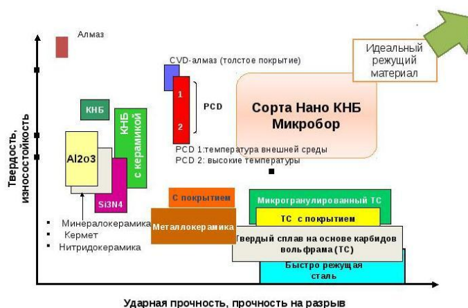
Рис. 1. Механические свойства современных инструментальных материалов
