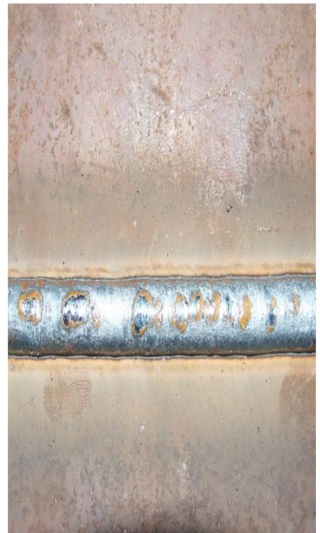
Рис. 1. Внешний вид швов полученных способом сварки с ИПЭП в CO<sub>2</sub> (а) и способом сварки с ИПЭП в смеси газов Ar+CO<sub>2</sub> (б)
