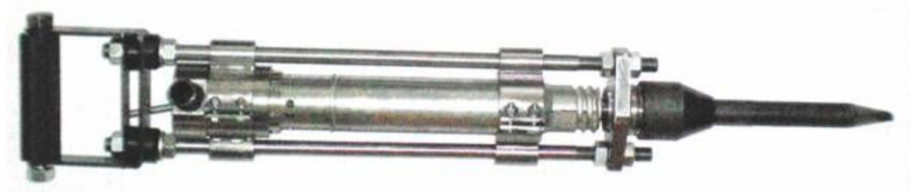
Рис. 4. Действующий макет пневматического отбойного молотка МО-4Д.
