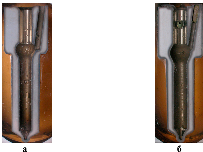
Рис. 2. Шлифы распылителей типоразмера «Р»: а - распылитель DLLA 146P600 фирмы Bosch; б – распылитель производства АЗПИ
