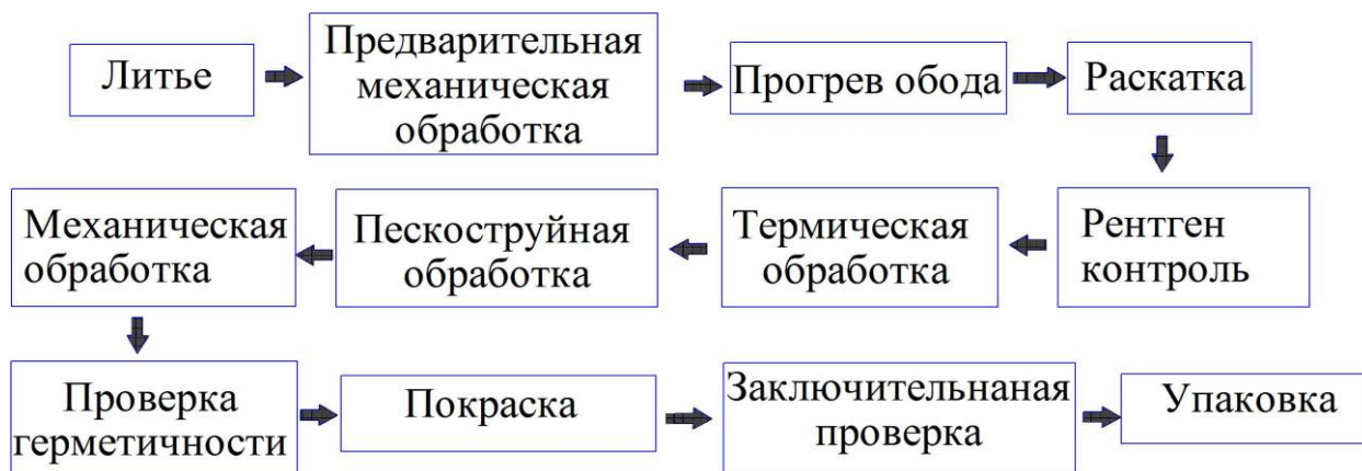
Рис. 5. Технология литья с раскаткой обода [20].
