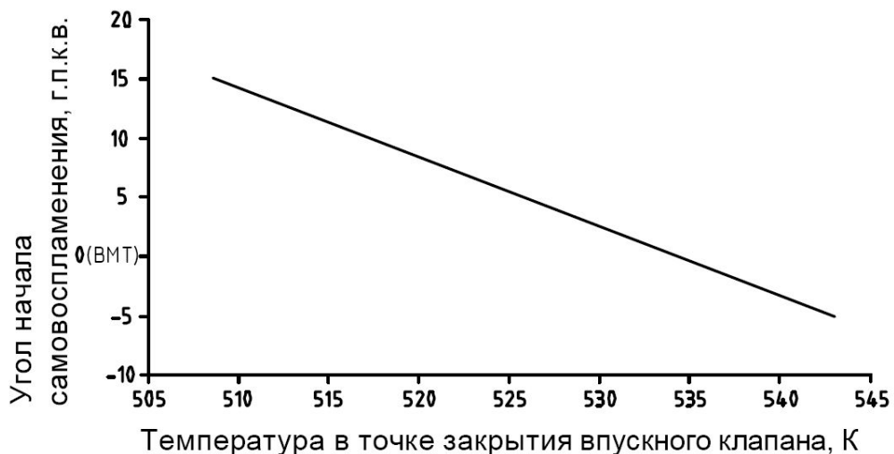
Рис. 2. Расчетная зависимость между температурой начала сжатия и моментом самовоспламенения
