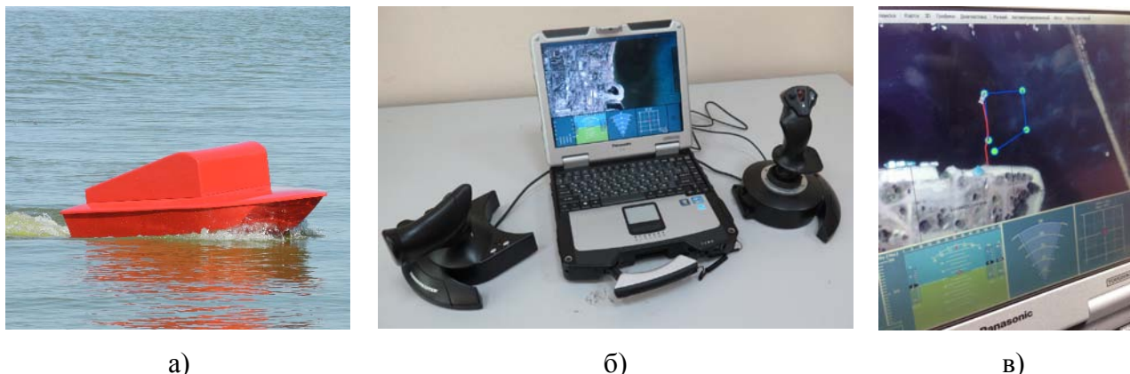
Рисунок 2. Внешний вид разработанного комплекса: а) автономный мини-корабль; б) наземный пункт управления; в) задание миссии мини-корабля
