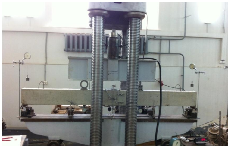
Рис. 2. Общий вид железобетонного образца на установке для испытания на изгиб.
