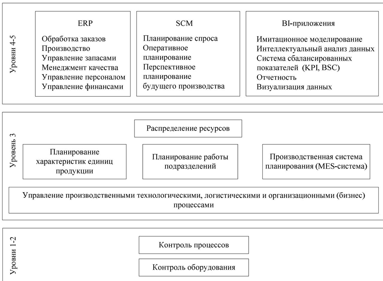
Рис. 1. Модель многоуровневой автоматизации в металлургической компании
