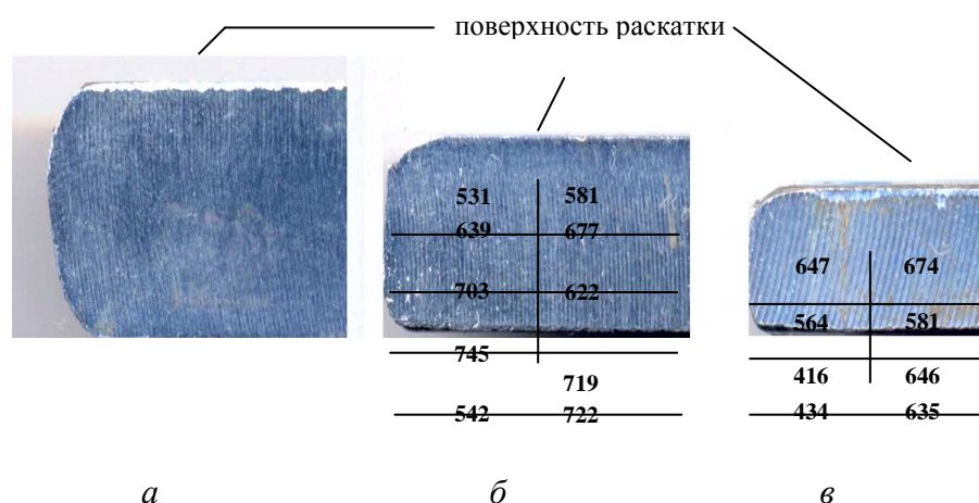
Рис. 3. Геометрия поперечных сечений раскатанной полосы при степенях обжатия: a - 4\% , b - 23\% , v - 40\% (цифрами обозначены значения предела текучести соответствующего слоя металла, МПа).
