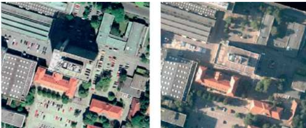
Рис. 4. Работа ортонормирующих программ. На правом изображении убрана вертикальная стена здания и видна проезжая часть, скрытая ранее впереди стоящим зданием
