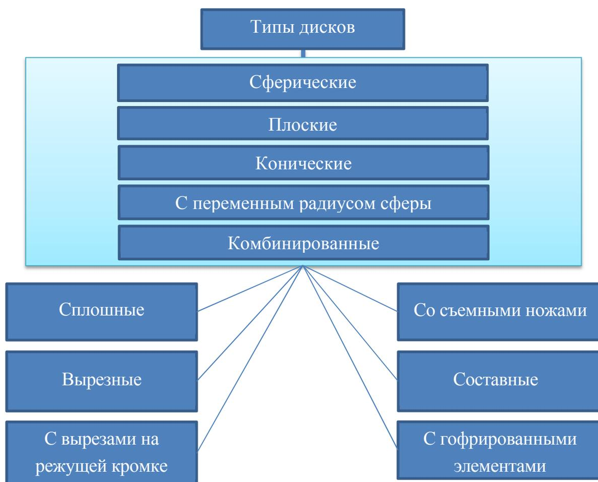
Рис. 1. Классификация дисковых рабочих органов почвообрабатывающих орудий
