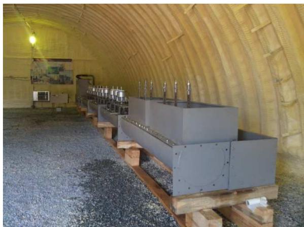
**Рисунок 2.** Экспериментальная установка для определения коэффициентов расхода гидротаранного агрегата и сопротивления клапанной коробки
