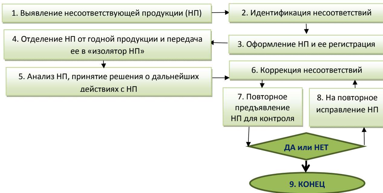
Рисунок 3. Блок-схема управления несоответствующей продукцией
