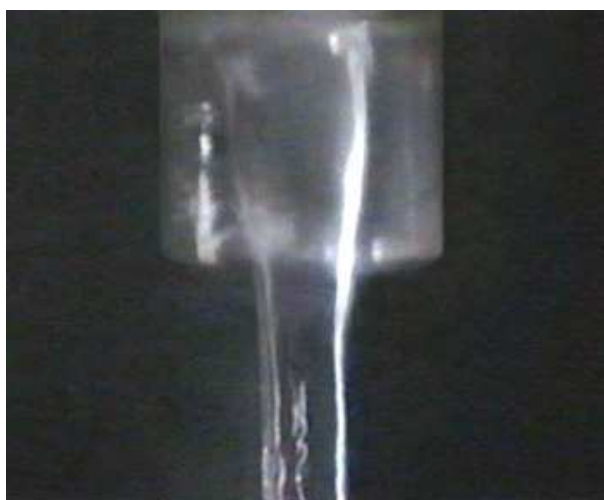
Рис. 4. Увеличение диаметра воздушного столба при входе в верхний выходной патрубок
