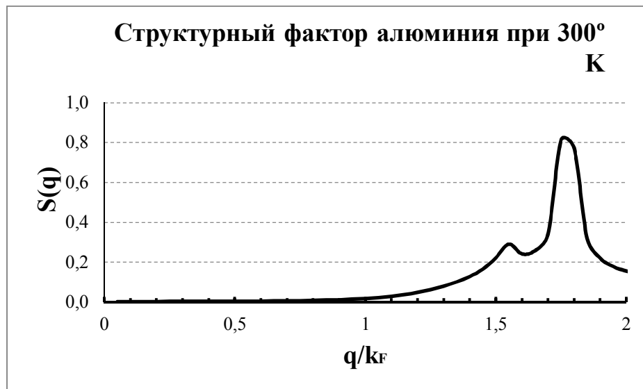
Рис. 3. Структурный фактор (Таблица 2) алюминия при расчете УЭС алюминия рассчитан в модели нецентральных сил с учетом взаимодействия только ближайших соседей по формулам (6). Модули упругости кристалла ГЦК алюминия при 300°К [15]:
