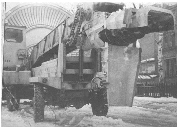
Рис.1 Брикезирующая установка на лаповом снегопогрузчике.
