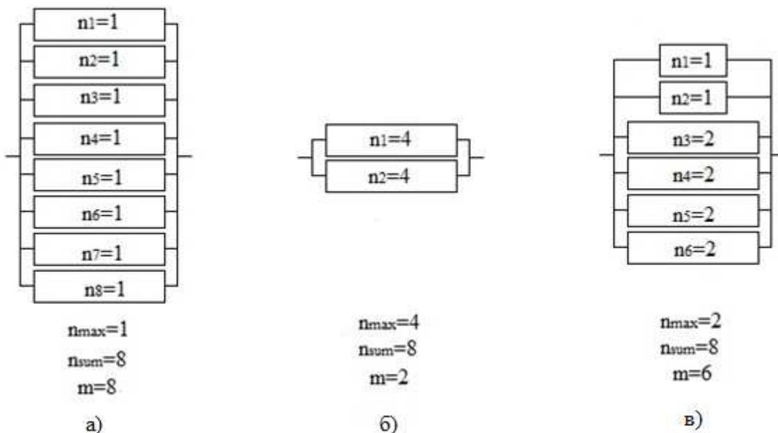
Рис. 1. Способы организации параллельного вычислительного процесса, содержащего 8 операций
