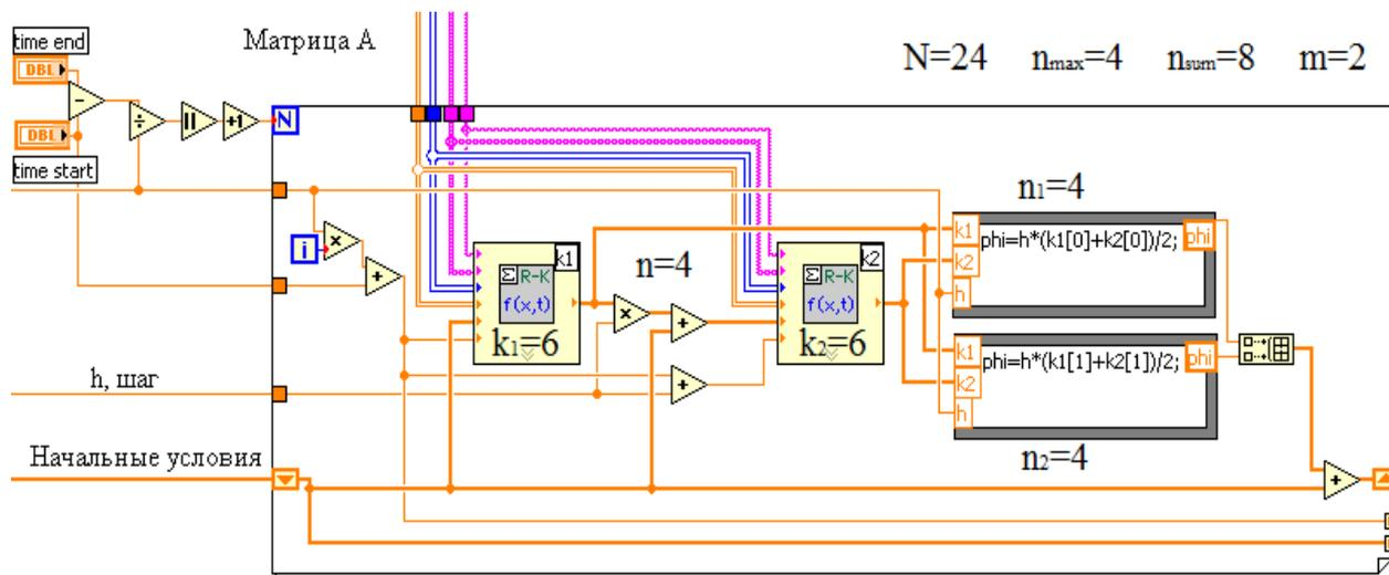
Рис. 2. Блок-диаграмма решателя ОДУ на основе метода РК2
