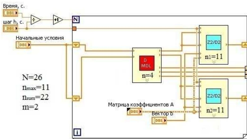
Рис. 3. Решатель на основе параллельного метода Д2
