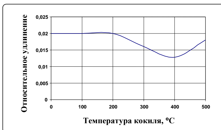
Рис. 5. Физико-механические свойства отливок из алюмотермитных сталей при различных условиях кристаллизации: относительное удлинение после разрыва от трения
