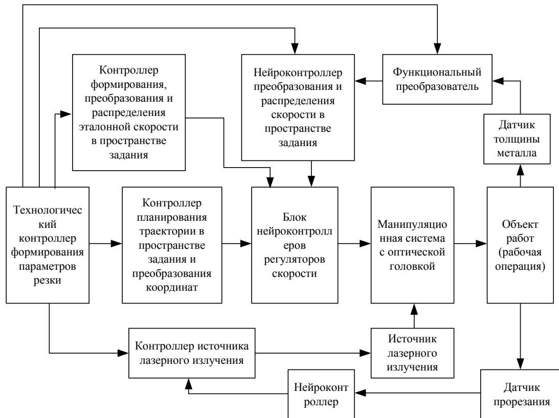
Рис. 2. Структурная схема системы управления движением
