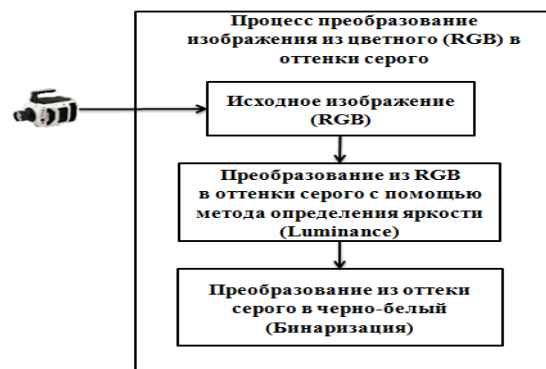
Рис. 2. процесс преобразования изображений из цветного в оттенки серого
