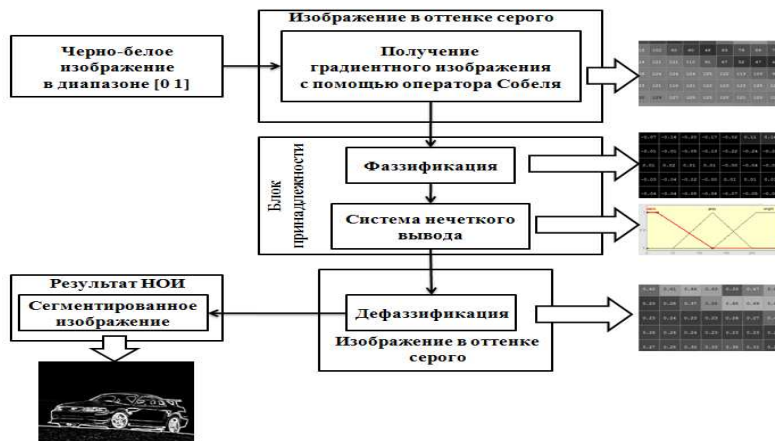
Рис. 4. Алгоритм нечеткой обработки изображений для выделения границ
