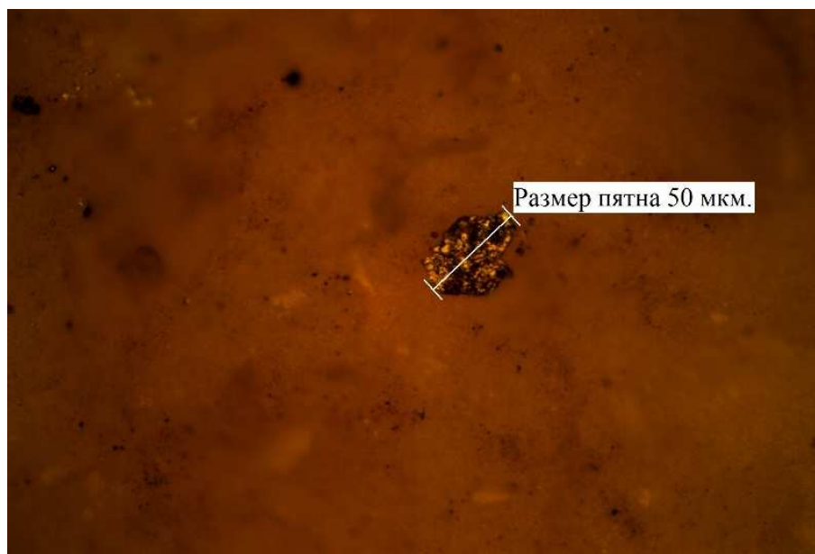
Рис. 5 – Поверхность керамики после обработки, x500.
