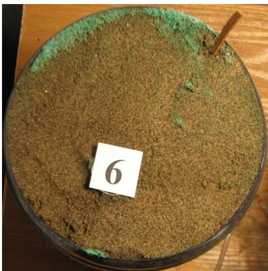
Рис. 2. Появление кристаллов \text{Ni}(\text{NiO}_3)_2 (а) и \text{Co}(\text{CoO}_3)_2 (б) на поверхности массива.
