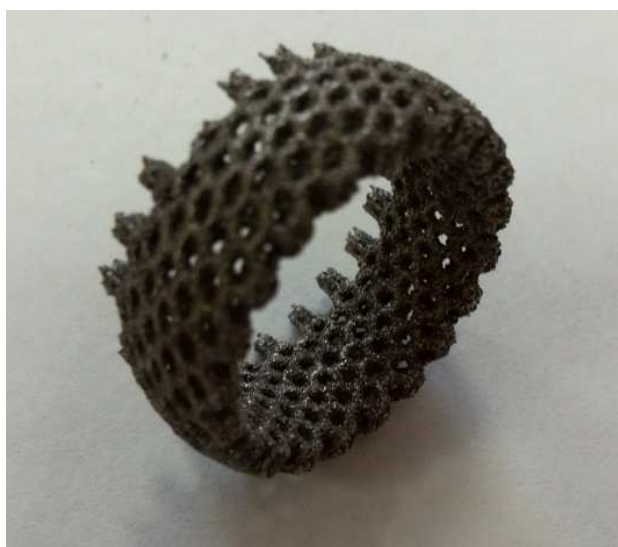
Рис 2. Высокопористый ячеистый образец, полученный в результате спекания
