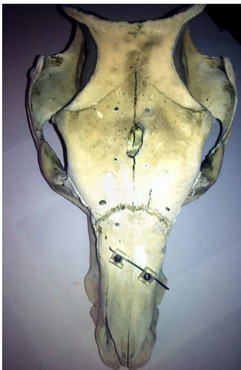
Рис.3. Модель системы для блочного компрессионного остеосинтеза костей лицевого скелета на носовых костях черепа свиньи.Использованы две мини-пластины и один отрезок металлической проволоки.
