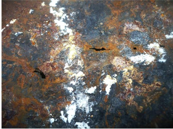
Рис. 2. Язвенное поле «разросшееся» по длине на дне трубы. Видны донные отложения
