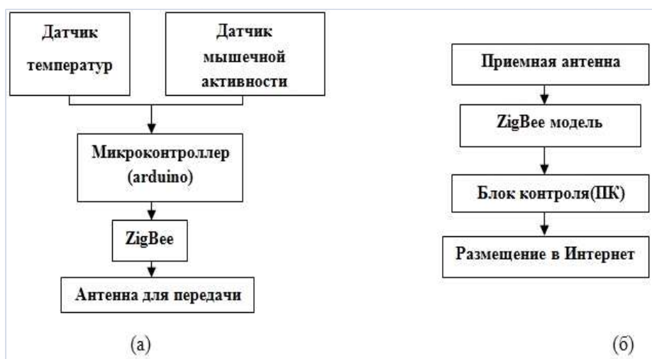
Рис.2. (а) Блок-схема системы передачи, (б) Блок схемы системы приема
