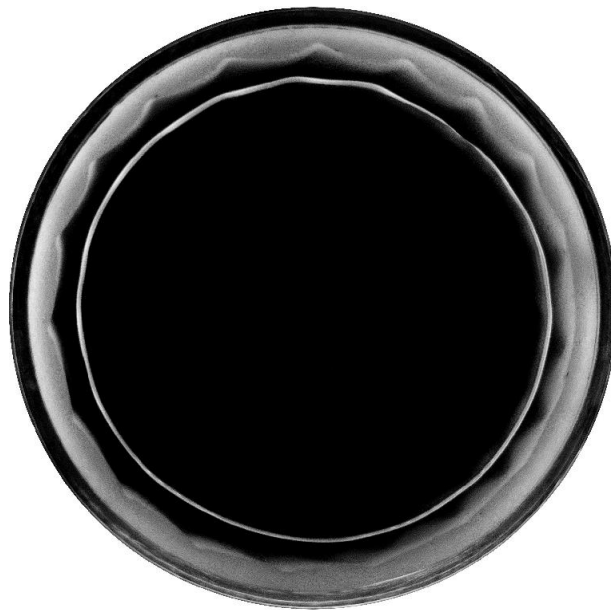
Рис. 2. Рельеф на границе раздела жидкость – сыпучая среда: \Omega = 35.2 \text{ с}^{-1} , \nu = 1.4 \text{ сСт} , m = 250 \text{ г} , q = 0.216 ; светлая линия демонстрирует границу раздела между жидкостью и воздухом; воздушный столб занимает центральную часть полости
