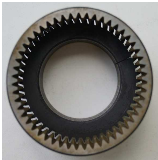
Рис. 3. Зубчатый венец, полученный на проволочно-вырезном станке
