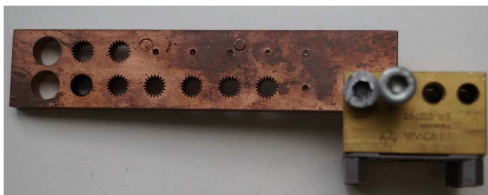
Рис. 2. Электрод-инструмент для получения внешнего зубчатого венца
