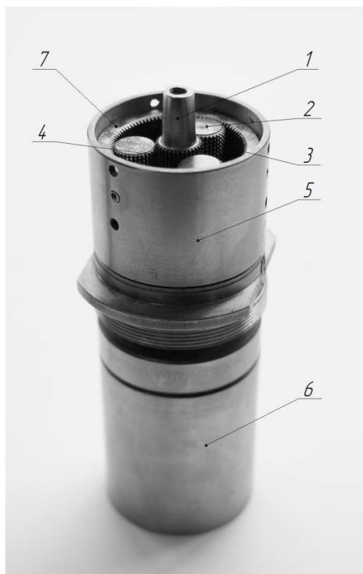
Рис. 1. Планетарный роликовинтовой механизм: 1 – винт, 2 – резьбовой ролик, 3 – зубчатые венцы на роликах, 4 – зубчатые винты на винте, 5 – опорная гайка, 6 – ходовая гайка, 7 – зубчатый эпицикл опорной гайки
