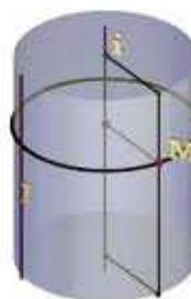
Рис.1,б - цилиндрическая поверхность вращения
