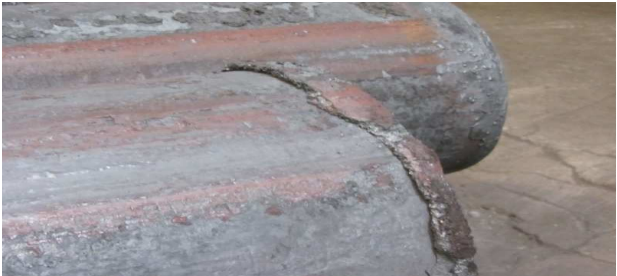
Рис. 1. Образование грата на торце непрерывно-литой заготовки после кислородной резки
