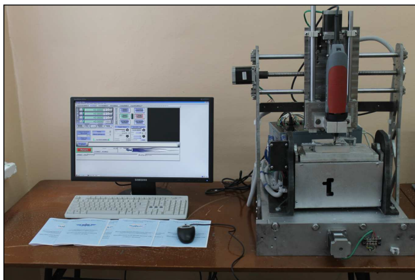
Рис. 5. Малогабаритный пятикоординатный станок с компьютерным управлением
