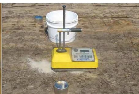
*в) плотномер радиоизотопный*
