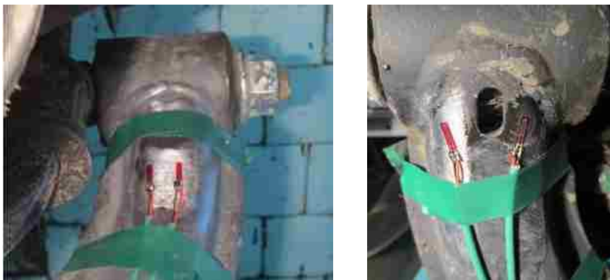
Рис.4. Установка тензорезисторов на рычаг подвески: а – верхняя часть рычага, б - нижняя часть рычага
