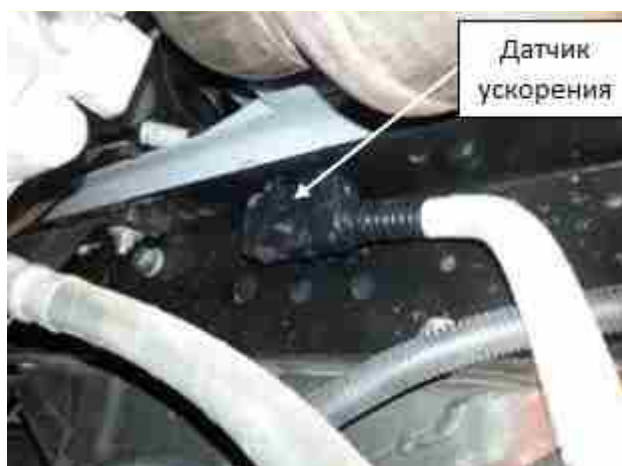
Рис. 3. Установка датчика ускорения
