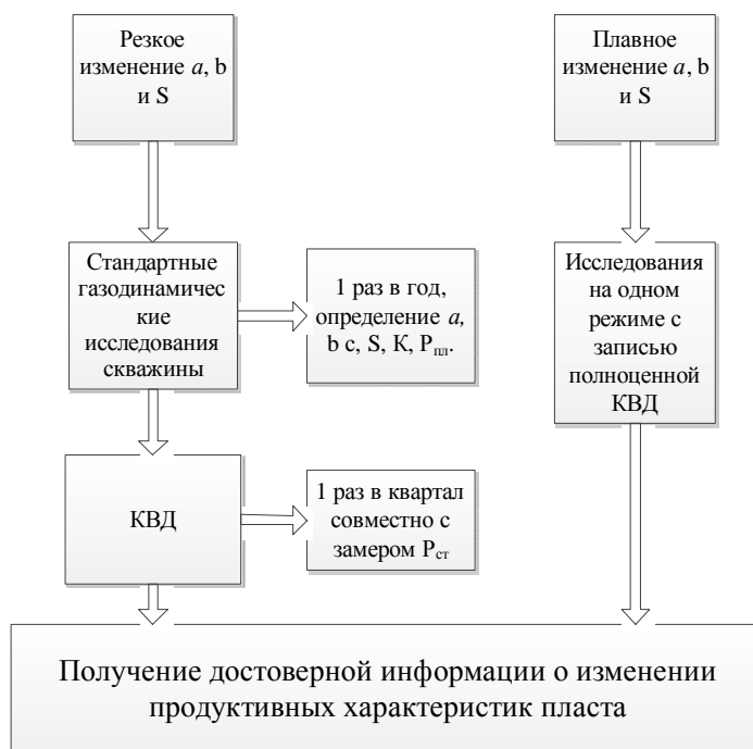
Рис. 2. Алгоритм оптимизации количества исследований в период постоянной добычи на газовых месторождениях
