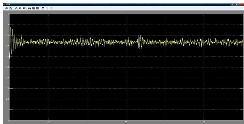
Рис. 2. Диаграммы cos φ , активной, реактивной, полной мощностей на стороне 6 кВ I секции при установке НБК
