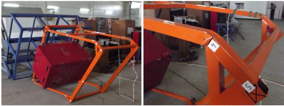
Рис. 5. Результаты натурного опрокидывания секции каркаса кузова.
