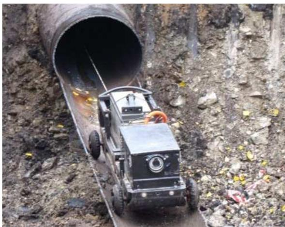
*Рис. 1. Телеинспекционный радиоуправляемый робот для диагностирования ПЗО*
