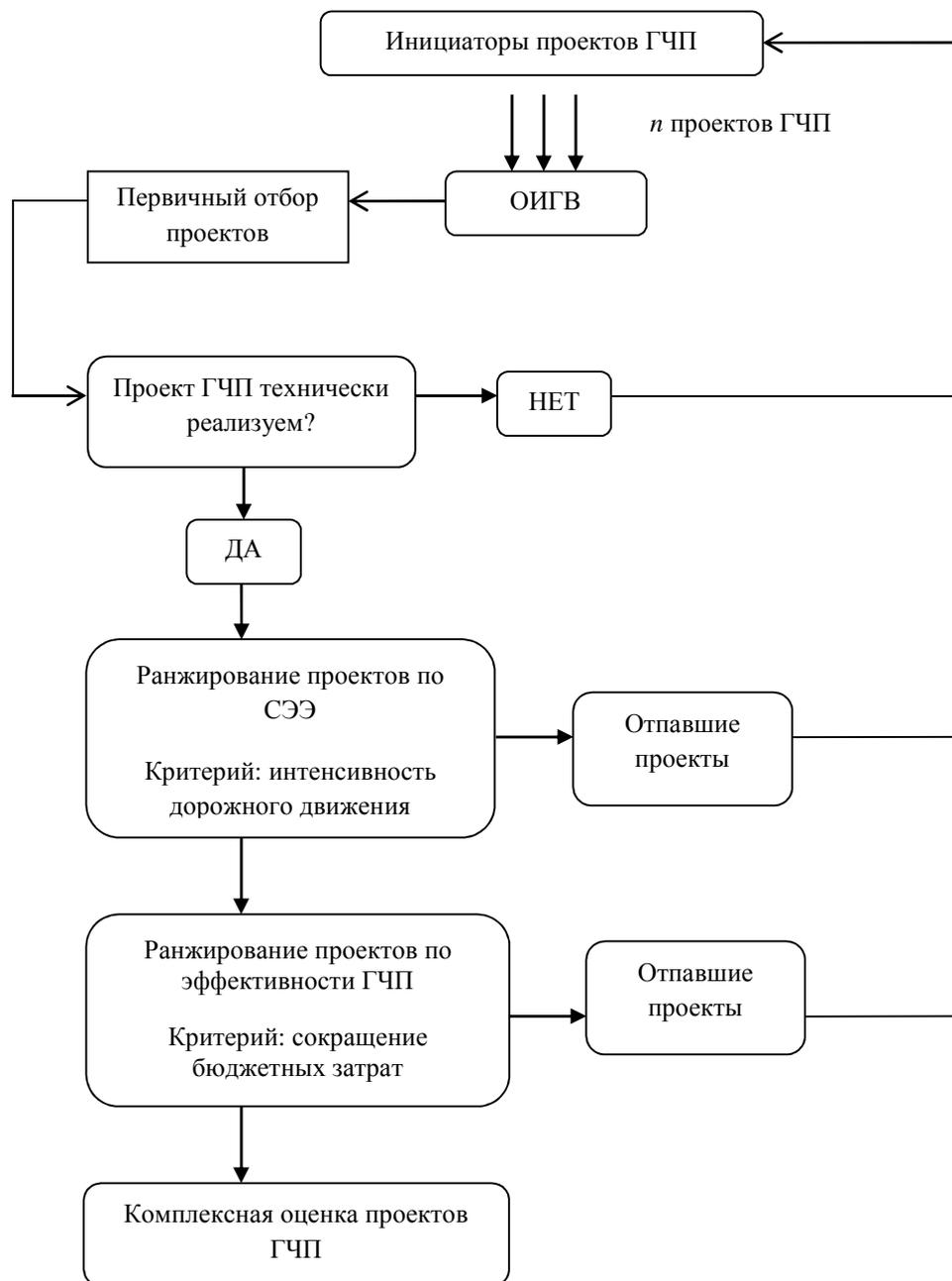
Рис.2. Алгоритм принятия решения о целесообразности применения ГЧП для обслуживания и ремонта автомобильных дорог на этапе инициации проекта
