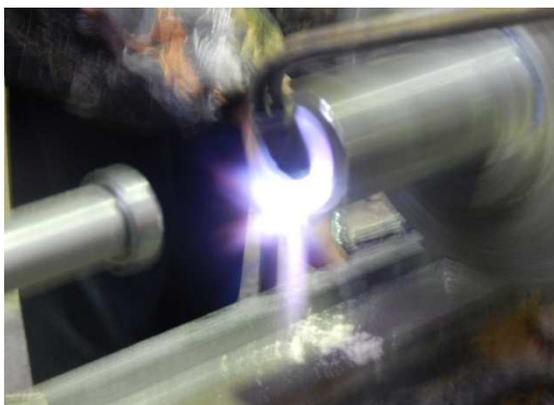
*Рис. 1. Процесс нагрева внутренней поверхности втулки перед накатыванием*
