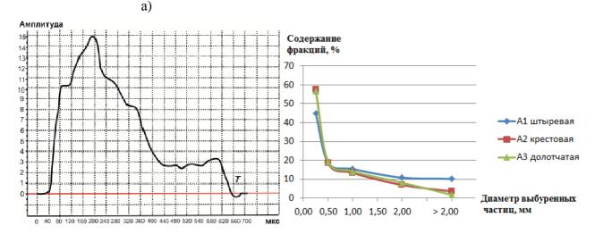
Амплитуда силы A = 14,9 mДлительность импульса T = 620 мксДлительность переднего фронта импульса t = 160 мкс
