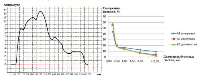
Амплитуда силы A = 13,4 т Длительность импульса T = 630 мкс Длительность переднего фронта импульса t = 230 мкс
