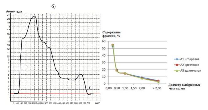
Амплитуда силы A=20,7 т Длительность импульса T=650 мкс Длительность переднего фронта импульса t=160 мкс
