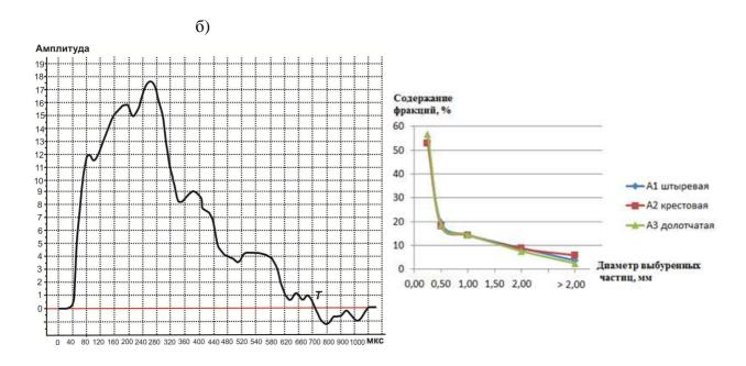
Амплитуда силы A=17,6 т Длительность импульса T=700 мкс Длительность переднего фронта импульса t=250 мкс
