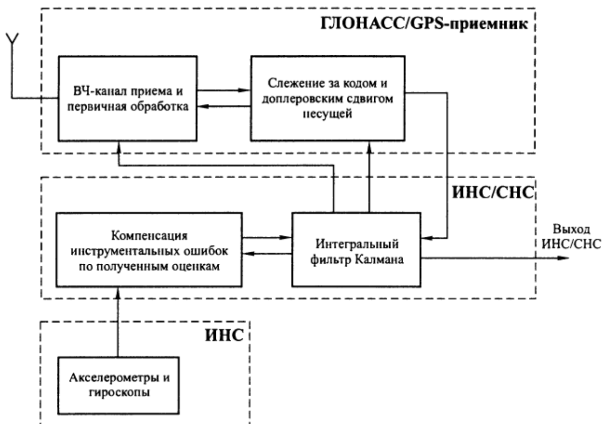
Рис. 3. Жестко связанная схема комплексирования ИНС и СНС
