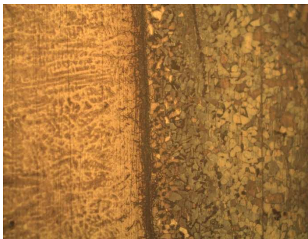
Рис. 2. Структура наплавленного металла в зоне сплавления основного металла с наплавленным металлом типа стали P18ЮH, \times 1000
