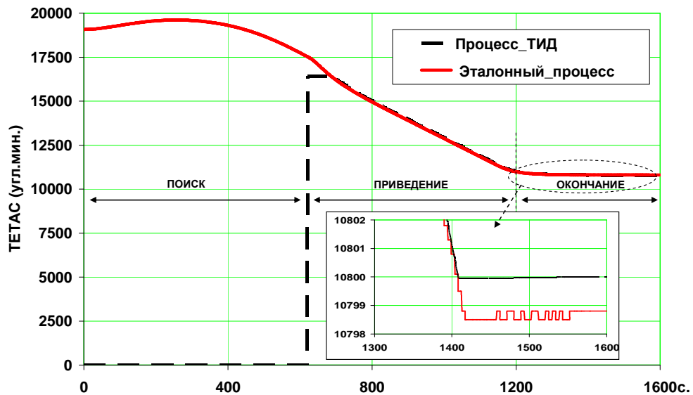
Рис. 4. Изменение углового положения Солнца в ССК по каналу тангажа
