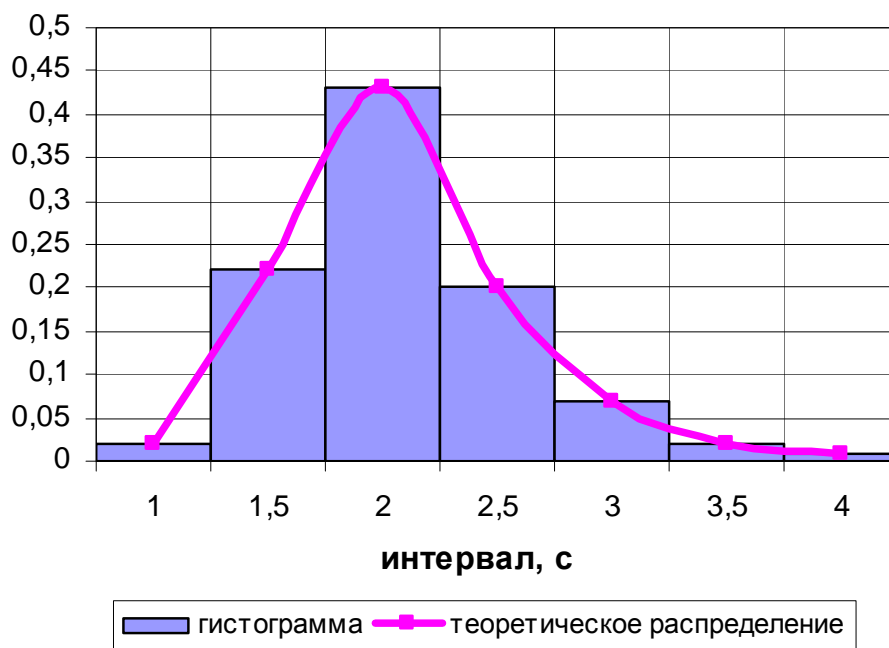
Рисунок 1. Распределение интервалов между легковыми автомобилями: 1- гистограмма; 2 – теоретическое распределение
