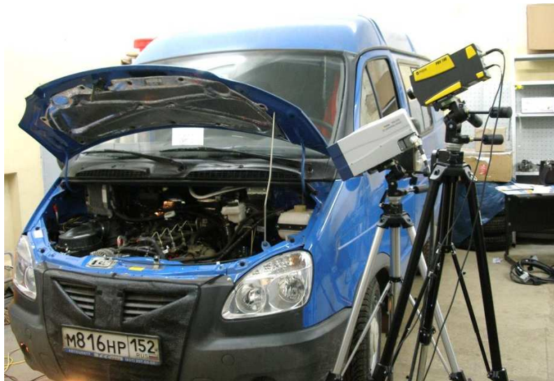
Рис. 1. Установка измерительных головок виброметров
