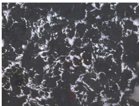
Рис. 4. Микрофотография шлифа образца состава 3: температура обжига 1100°C, увеличение x50
