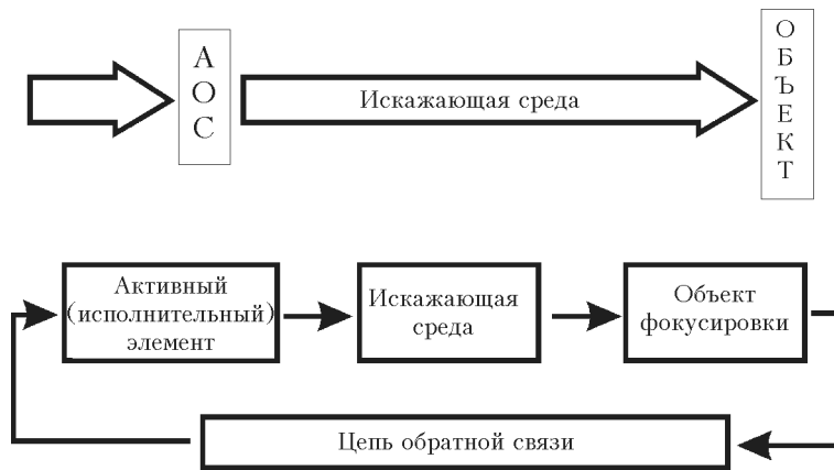
Рис. 1. Структура адаптивной системы, предназначенной для коррекции атмосферных искажений излучения
